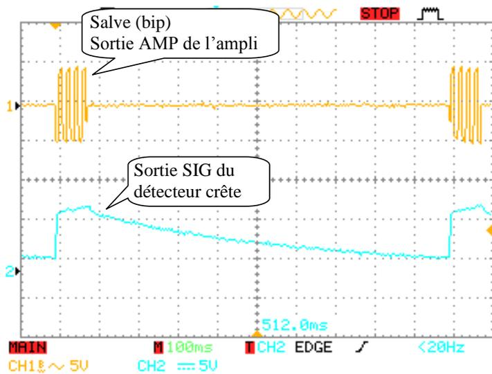
La valeur maximum du signal en sortie du détecteur suivra l'amplitude des sinusoïdes du signal en sortie de l'ampli.
