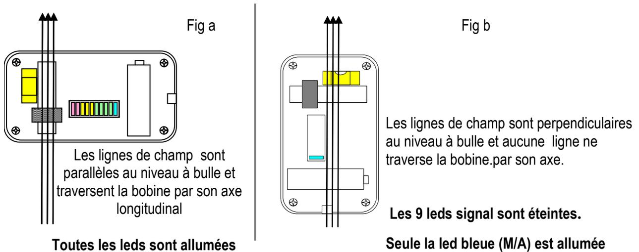
La recherche de la position menant à l'extinction des « leds signals » donnera l'orientation des lignes du champ magnétique.
