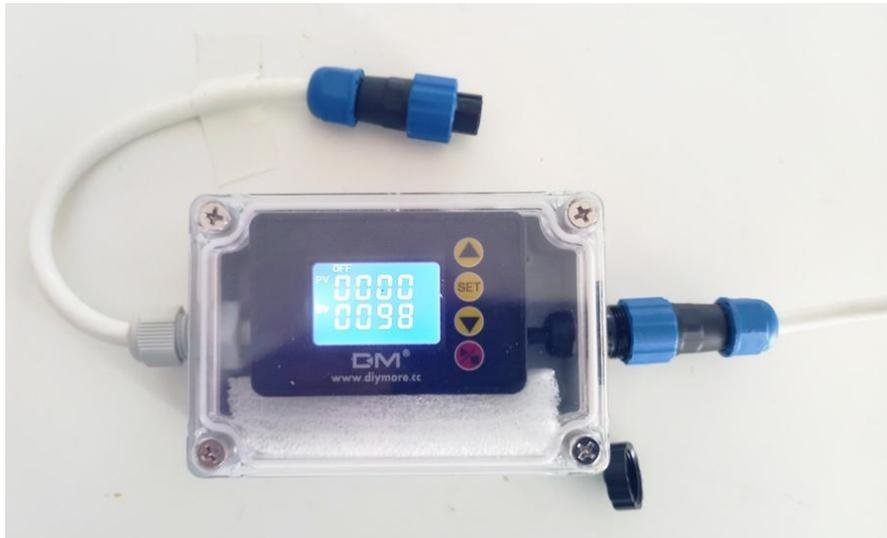
Une minuterie GM placée dans un boîtier s'intercale entre l'alimentation et la charge. La charge se trouve donc directement alimentée par l'alimentation via la minuterie.
