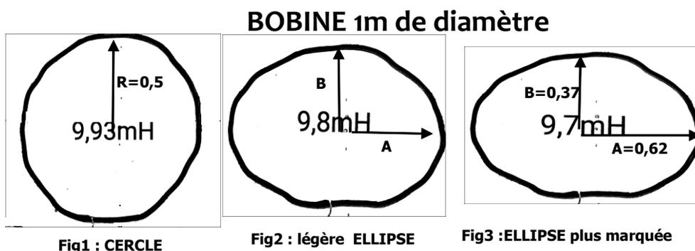
Avec un condensateur, on a accordé la bobine quand elle est circulaire(fig 1) Sur les fig2 et 3 le circuit sera légèrement désaccordé. Pour quantifier l'effet de ce désaccord, on a alimenté la bobine avec son condensateur par l'émetteur et à une dizaine de mètres on a mesuré le signal délivré par le cadre récepteur.
