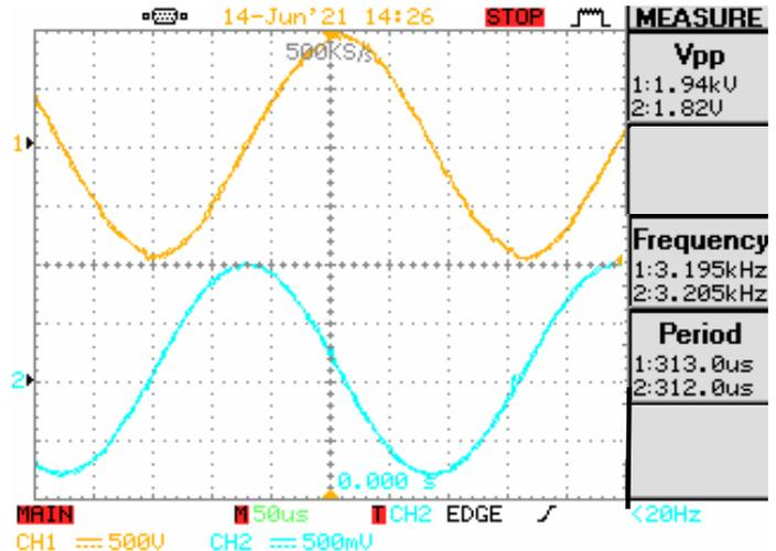
Lorsque la batterie 6S2P vient d'être chargée, sa tension atteint 27,2V, l'amplitude du courant est environ de 5A et celle de la tension dépasse légèrement 1000V.
