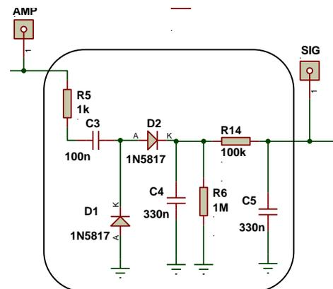
On a choisi des diodes de type Schottky 1N5817 car elles ont un faible seuil, ce qui permet de baisser le seuil de détection du détecteur.
