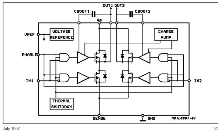
On voit qu'en plus des entrées IN1 et IN2, il dispose d'une entrée Enable (Autorisation) qui à 0 bloque les commandes IN1 et IN2 ainsi que les 4 transistors du pont, ce qui a pour effet d'annuler le courant de sortie. C'est cette entrée Enable qui est utilisée pour fixer la durée (80ms) et la périodicité des bip (1s).
