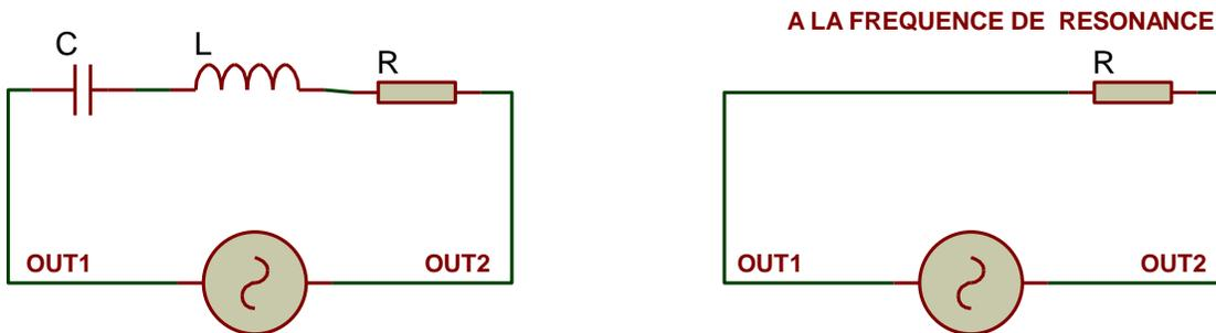
On montre que la réactance du condensateur  $1/C\omega$  se soustrait à celle de la bobine  $L\omega$ . Pour une fréquence  $f_0$  correspondant à une pulsation  $\omega_0$ , telle que  $L\omega_0=1/C\omega_0$ , Les réactances sont égales. La réactance totale devient nulle et l'impédance du circuit RLC se réduit à la résistance R. Le courant devient très grand, on parle de résonance.
