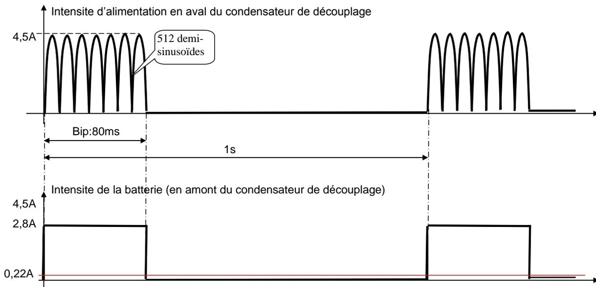
Du fait du lissage du condensateur de découplage, idéalement on retrouve un courant en sortie de la batterie quasiment constant à 2,8A durant le bip.
