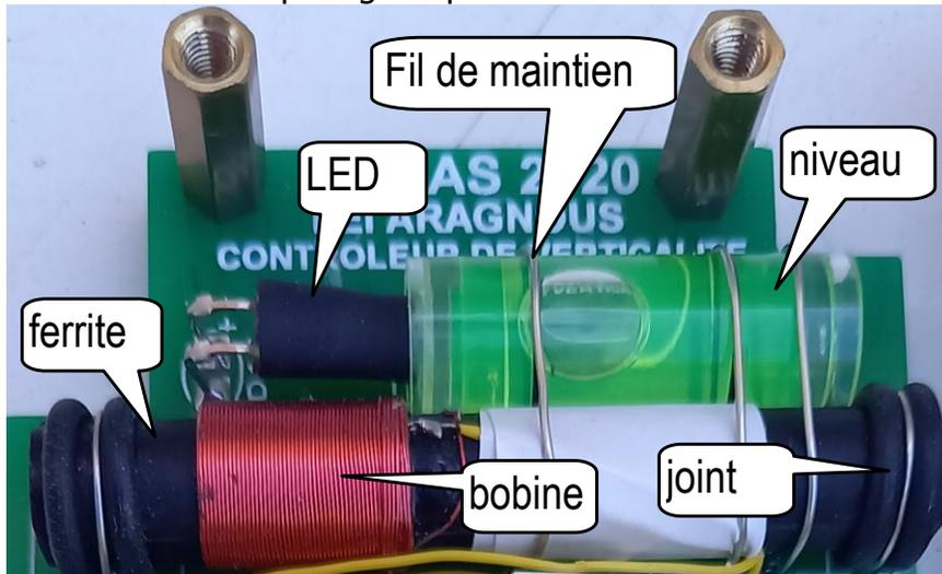
Le niveau est maintenu sur la ferrite à l'aide de 2 fils électriques rigides soudés sur la carte. La ferrite est maintenue à ses extrémités par 2 autres fils soudés sur la carte. Autour de la ferrite on a placé des joints toriques en caoutchouc pour compenser l'épaisseur de la bobine et comme amortissement.
