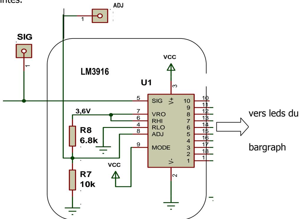
Pour le LM3916 le nombre de leds allumés est fonction logarithmique de la tension d'entrée, ce qui permet d'accroître la dynamique de mesure.
